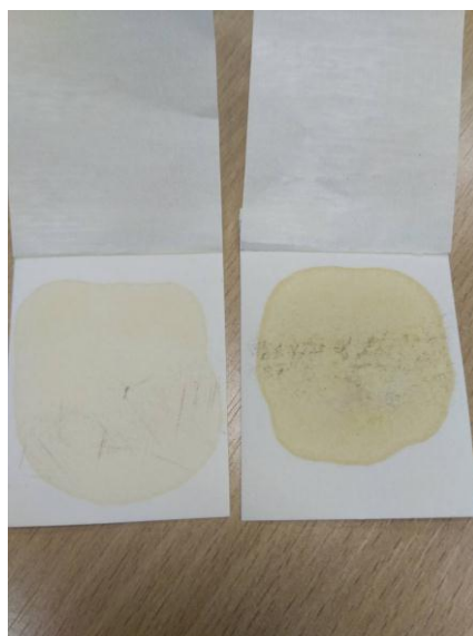
6 pav. PenTest D4D testai, pirmame teste (kairėje pusėje) – reakcijos nėra, narkotinių medžiagų neaptikta, o antrame teste (dešinėje pusėje) – reakcija įvykus, aptikti narkotinių medžiagų pėdsakai
